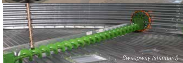
Fejesneglen kan også leveres med ekstra reduceret hastighed på træk hjulet, gearing 16:1 ▼
