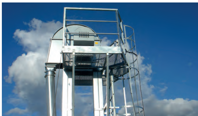
▲ Till fristående skopelevatorer kan serviceplattform vid elevator topp samt stege med ryggskydd levereras.
