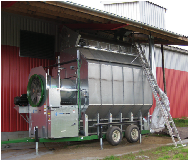
▲ DC 12 vaunukuivuri aksiaalipuhaltimella.
