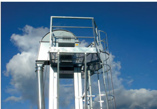
▲ Elevaattorin putkessa huoltotaso ja tikkaat suojakaiteella vapaastiseisovassa kuppielevaattorissa.
