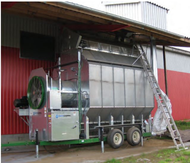
▲ DC 12 mobiltørneri med axial blæser
