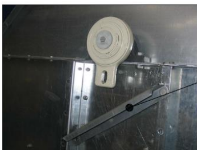
Beslag for tilbageløbsspærre, afmonteres delvis
