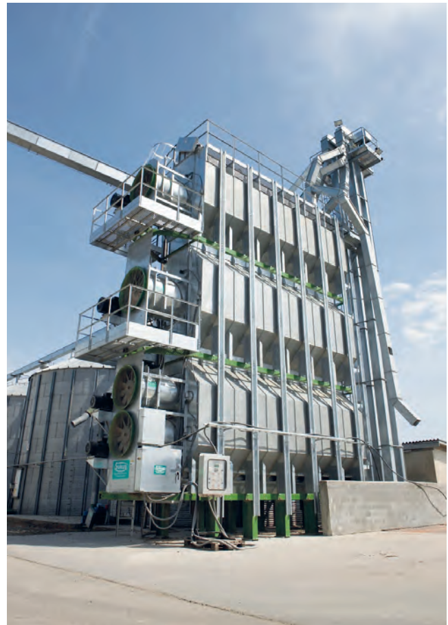
2 moduls stack tørrieri med kapacitet op til 78 t/h 3 moduls stack tørrieri med kapacitet op til 117 t/h
