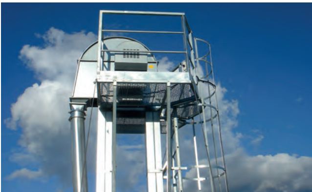
▲ Til fritstående kopelevatorer kan leveres serviceplatform ved elevatorstop samt lejder med rygbojle på elevatorør.
